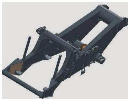
Okvir ima ravnu šinu i bešavne cijevi poprečne grede kako bi se eliminirali izvori koncentracije naprezanja. Glavne šine varijabilnog presjeka smanjuju naprezanje i povećavaju vijek trajanja okvira. Poprečna struktura bešavnih cijevi povećava otpornost na torziju. Proces potopnog elektrolučnog zavarivanja dodatno smanjuje naprezanje sa zavarenim spojevima s punim prodom, što povećava vijek trajanja okvira.
